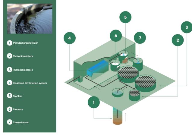
Direction of the water treatment process. Dirección del proceso de tratamiento del agua.
